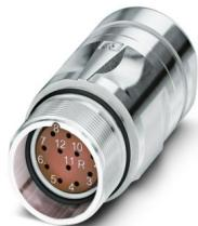
M23, Connnettore per giunti, serie: CA, diritto, schermati: sì, per bloccaggio standard e SPEEDCON, Numero di poli: 17, Senso di rotazione: standard, tipo di connessione del contatto: Femmina, Connessione a crimpire, diametro cavi: 4 mm ... 6 mm, codifica: N, Prodotto alternativo secondo RoHS II senza eccezione 6c (Pb < 0,1 %) cod. art.: 1243946
