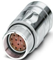
M23, Connnettore per giunti, serie: CA, diritto, schermati: sì, per bloccaggio standard e SPEEDCON, Numero di poli: 12, Senso di rotazione: Invertito, tipo di connessione del contatto: Femmina, Connessione a crimpere, diametro cavi: 10 mm ... 14,5 mm, codifica: N, Prodotto alternativo secondo RoHS II senza eccezione 6c (Pb < 0,1 %) cod. art.: 1243938
