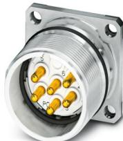
M23, Connnettore per apparecchi anteriore, serie: CA, diritto, schermati: sì, per bloccaggio standard e SPEEDCON, Numero di poli: 7, Senso di rotazione: standard, tipo di connessione del contatto: Spina, Connessione a crimpire, Guarnizione piatta, 4x Ø 3,2, misura flangia: 25 mm x 25 mm, codifica: N
