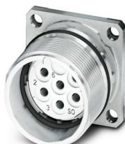
M23, Connettore per apparecchi anteriore, serie: CA, diritto, schermati: sì, per bloccaggio standard e SPEEDCON, Numero di poli: 8+1, Senso di rotazione: standard, tipo di connessione del contatto: Femmina, Attacco a saldare, Guarnizione piatta, 4x Ø 3,2, misura flangia: 25 mm x 25 mm, codifica: N, Prodotto alternativo secondo RoHS II senza eccezione 6c (Pb < 0,1 %) cod. art.: 1243928
