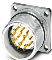
M23, Connettore per apparecchi anteriore, serie: CA, diritto, schermati: sì, per bloccaggio standard e SPEEDCON, Numero di poli: 17, Senso di rotazione: standard, tipo di connessione del contatto: Spina, Connessione a saldare, Guarnizione piatta, 4x Ø 3,2, misura flangia: 25 mm x 25 mm, codifica: N, Prodotto alternativo secondo RoHS II senza eccezione 6c (Pb < 0,1 %) cod. art.: 1243895
