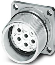
M23, Connettore per apparecchi anteriore, serie: CA, diritto, schermati: sì, per bloccaggio standard e SPEEDCON, Numero di poli: 6, Senso di rotazione: standard, tipo di connessione del contatto: Femmina, Connessione a saldare, Guarnizione piatta, 4x Ø 3,2, misura flangia: 25 mm x 25 mm, codifica: N, Prodotto alternativo secondo RoHS II senza eccezione 6c (Pb < 0,1 %) cod. art.: 1243894
