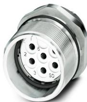
M23, Connettore per apparecchi anteriore, serie: CA, diritto, schermati: sì, per bloccaggio standard e SPEEDCON, Numero di poli: 7, Senso di rotazione: standard, tipo di connessione del contatto: Femmina, Connessione a crimpere, Guarnizione assiale, Fissaggio centrale Pg13,5, codifica: N
