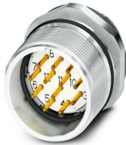
M23, Connnettore per apparecchi anteriore, serie: CA, diritto, schermati: sì, per bloccaggio standard e SPEEDCON, Numero di poli: 12, Senso di rotazione: standard, tipo di connessione del contatto: Spina, Attacco a saldare, Guarnizione assiale, Fissaggio centrale Pg13,5, codifica: N, Prodotto alternativo secondo RoHS II senza eccezione 6c (Pb < 0,1 %) cod. art.: 1243875
