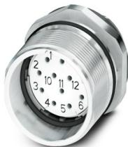
M23, Connnettore per apparecchi anteriore, serie: CA, diritto, schermati: sì, per bloccaggio standard e SPEEDCON, Numero di poli: 16+3, Senso di rotazione: standard, tipo di connessione del contatto: Femmina, Attacco a saldare, Guarnizione assiale, Fissaggio centrale Pg13,5, codifica: N, Prodotto alternativo secondo RoHS II senza eccezione 6c (Pb < 0,1 %) cod. art.: 1243870
