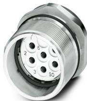
M23, Connnettore per apparecchi anteriore, serie: CA, diritto, schermati: sì, per bloccaggio standard e SPEEDCON, Numero di poli: 8+1, Senso di rotazione: standard, tipo di connessione del contatto: Femmina, Connessione a crimpature, Guarnizione assiale, Fissaggio centrale M20 x 1,5, codifica: N
