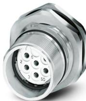
M23, Connnettore per apparecchi posteriore, serie: CA, diritto, schermati: sì, per bloccaggio standard e SPEEDCON, Numero di poli: 6, Senso di rotazione: standard, tipo di connessione del contatto: Femmina, Attacco a saldare, Guarnizione assiale, Fissaggio centrale, codifica: N, Prodotto alternativo secondo RoHS II senza eccezione 6c (Pb < 0,1 %) cod. art.: 1243854
