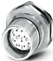
M23, Connettore per apparecchi posteriore, serie: CA, diritto, schermati: sì, per bloccaggio standard e SPEEDCON, Numero di poli: 12, Senso di rotazione: standard, tipo di connessione del contatto: Femmina, Attacco a saldare, Guarnizione assiale, Fissaggio centrale, codifica: N, Prodotto alternativo secondo RoHS II senza eccezione 6c (Pb < 0,1 %) cod. art.: 1243842
