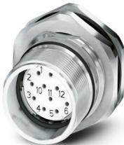
M23, Connettore per apparecchi posteriore, serie: CA, diritto, schermati: sì, per bloccaggio standard e SPEEDCON, Numero di poli: 16+3, Senso di rotazione: standard, tipo di connessione del contatto: Femmina, Attacco a saldare, Guarnizione assiale, Fissaggio centrale, codifica: N, Prodotto alternativo secondo RoHS II senza eccezione 6c (Pb < 0,1 %) cod. art.: 1243830
