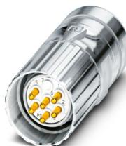
M23, Connnettore per cavi, serie: CA, diritto, schermati: sì, Bloccaggio a vite, Numero di poli: 7, Senso di rotazione: standard, tipo di connessione del contatto: Spina, Attacco a saldare, diametro cavi: 4 mm ... 6 mm, codifica: N, Prodotto alternativo secondo RoHS II senza eccezione 6c (Pb < 0,1 %) cod. art.: 1243797
