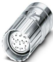
M23, Connnettore per cavi, serie: CA, diritto, schermati: sì, Bloccaggio a vite, Numero di poli: 12, Senso di rotazione: standard, tipo di connessione del contatto: Femmina, Attacco a saldare, diametro cavi: 4 mm ... 6 mm, codifica: N, Prodotto alternativo secondo RoHS II senza eccezione 6c (Pb < 0,1 %) cod. art.: 1243790
