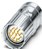
M23, Connnettore per cavi, serie: CA, diritto, schermati: sì, Bloccaggio a vite, Numero di poli: 16, Senso di rotazione: standard, tipo di connessione del contatto: Spina, Attacco a saldare, diametro cavi: 4 mm ... 6 mm, codifica: N, Prodotto alternativo secondo RoHS II senza eccezione 6c (Pb < 0,1 %) cod. art.: 1243785
