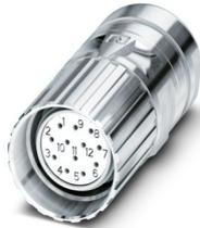
M23, Connettore per cavi, serie: CA, diritto, schermati: sì, Bloccaggio a vite, Numero di poli: 16+3, Senso di rotazione: standard, tipo di connessione del contatto: Femmina, Attacco a saldare, diametro cavi: 4 mm ... 6 mm, codifica: N, Prodotto alternativo secondo RoHS II senza eccezione 6c (Pb < 0,1 %) cod. art.: 1243778
