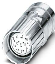
M23, Connnettore per cavi, serie: CA, diritto, schermati: sì, Bloccaggio a vite, Numero di poli: 16, Senso di rotazione: standard, tipo di connessione del contatto: Femmina, Attacco a saldare, diametro cavi: 6 mm ... 10 mm, codifica: N, Prodotto alternativo secondo RoHS II senza eccezione 6c (Pb < 0,1 %) cod. art.: 1243758
