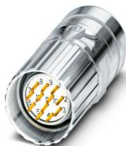
M23, Connnettore per cavi, serie: CA, diritto, schermati: sì, Bloccaggio a vite, Numero di poli: 17, Senso di rotazione: standard, tipo di connessione del contatto: Spina, Attacco a saldare, diametro cavi: 6 mm ... 10 mm, codifica: N, Prodotto alternativo secondo RoHS II senza eccezione 6c (Pb < 0,1 %) cod. art.: 1243753
