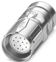
M23, Connnettore per cavi, serie: CA, diritto, schermati: sì, SPEEDCON, Numero di poli: 16, Senso di rotazione: standard, tipo di connessione del contatto: Femmina, Connessione a crimpire, diametro cavi: 6 mm ... 10 mm, codifica: N, Prodotto alternativo secondo RoHS II senza eccezione 6c (Pb < 0,1 %) cod. art.: 1243626
