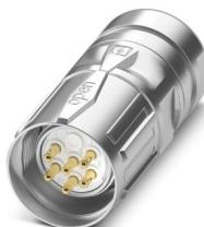
M23, Connnettore per cavi, serie: CA, diritto, schermati: sì, SPEEDCON, Numero di poli: 8+1, Senso di rotazione: standard, tipo di connessione del contatto: Spina, Connessione a crimpere, diametro cavi: 10 mm ... 14,5 mm, codifica: N, Prodotto alternativo secondo RoHS II senza eccezione 6c (Pb < 0,1 %) cod. art.: 1243607
