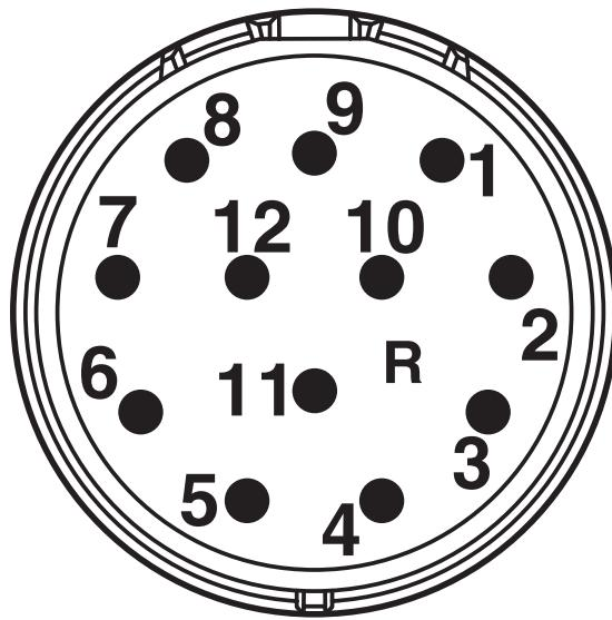
Numerazione camera contatti (visualizzazione lato innesto) connettore maschio standard
