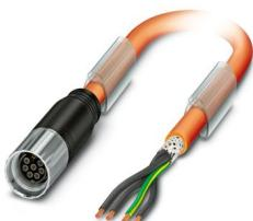
Conduttori per cavi rivestiti in materiale plastico mediante stampaggio, serie: KST, M17-Femmina, sovrastampato in materia plastica dritto, numero poli: 7+PE, tipo di bloccaggio: Bloccaggio a vite, lunghezza cavo: 10 m, schermata: sì, colore guaina esterna: arancio RAL 2003
