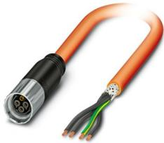
Conduttori per cavi rivestiti in materiale plastico mediante stampaggio, serie: KST, M17-Femmina, sovrastampato in materia plastica dritto, numero poli: 3+PE, tipo di bloccaggio: Bloccaggio a vite, lunghezza cavo: 2 m, schermata: sì, colore guaina esterna: arancio RAL 2003, Questo articolo è in continuo adattamento. Alternativa senza piombo secondo RoHS II senza eccezione 6c (Pb < 0,1%) possibile in anticipo su richiesta.
