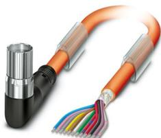
Conduttori per cavi rivestiti in materiale plastico mediante stampaggio, angolato orientabile, - 120° a sinistra / 120° a destra, numero poli: 12, tipo di bloccaggio: Bloccaggio a vite, lunghezza cavo: 10 m, schermata: sì, colore guaina esterna: arancio RAL 2003
