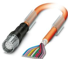
Conduttori per cavi rivestiti in materiale plastico mediante stampaggio, sovrastampato in materia plastica dritto, numero poli: 12, tipo di bloccaggio: Bloccaggio a vite, lunghezza cavo: 10 m, schermata: sì, colore guaina esterna: arancio RAL 2003
