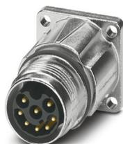
Connettore per apparecchi anteriore, diritto, per bloccaggio standard e SPEEDCON, M17, numero poli: 8, tipo di connessione del contatto: Spina, schermata: sì, misura flangia: 21,6 mm x 21,6 mm, numero poli: 8, tipo di connessione: Connessione a crimpare, serie: ST
