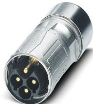
Connettore per cavi, diritto, SPEEDCON, M17, numero poli: 5+PE, tipo di connessione del contatto: Spina, schermata: sì, grado di protezione: IP67, diametro cavi: 3,5 mm ... 5,5 mm, numero poli: 6, tipo di connessione: Connessione a crimpare, serie: ST, Questo articolo è in continuo adattamento. Alternativa senza piombo secondo RoHS II senza eccezione 6c (Pb < 0,1%) possibile in anticipo su richiesta.
