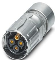
Connettore per cavi, diritto, SPEEDCON, M17, numero poli: 3+PE, tipo di connessione del contatto: Femmina, schermata: sì, grado di protezione: IP67, diametro cavi: 11 mm ... 12,7 mm, numero poli: 4, tipo di connessione: Connessione a crimpire, serie: ST, Questo articolo è in continuo adattamento. Alternativa senza piombo secondo RoHS II senza eccezione 6c (Pb < 0,1%) possibile in anticipo su richiesta.
