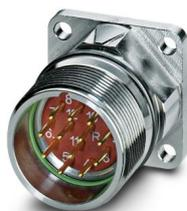
Connettore per apparecchi anteriore, diritto, Bloccaggio a vite, M23, numero poli: 12, tipo di connessione del contatto: Spina, O-ring assiale, 4x Ø 3,2, schermata: sì, numero poli: 12, tipo di connessione: Connessione a crimpare, serie: RF
