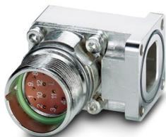
Connettore per apparecchi anteriore, angolato, fisso, Bloccaggio a vite, M23, numero poli: 16, tipo di connessione del contatto: Femmina, O-ring assiale, 4x Ø 3,2, schermata: sì, misura flangia: 26 mm x 26 mm, numero poli: 16, tipo di connessione: Connessione a crimpare, serie: RF, Questo articolo è in continuo adattamento. Alternativa senza piombo secondo RoHS II senza eccezione 6c (Pb < 0,1%) possibile in anticipo su richiesta.
