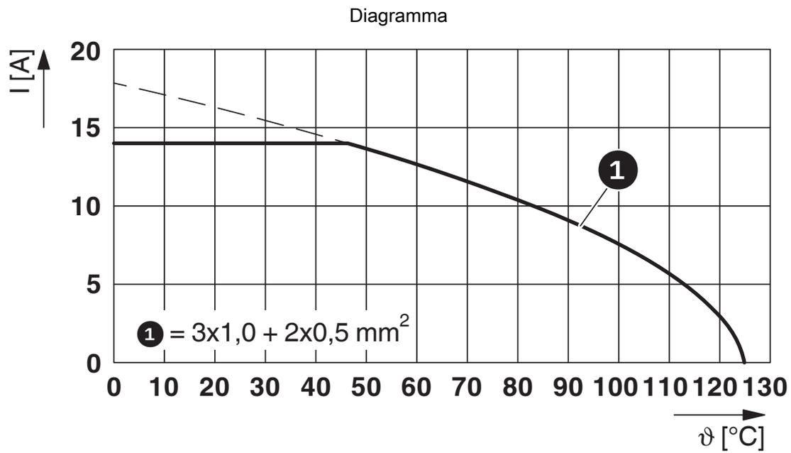
$I$  = intensità di corrente,  $\vartheta$  = temperatura ambiente, 3 x 14 A + 2 x 2 A costante
