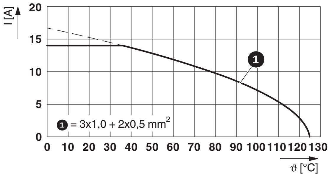
$I$  = intensità di corrente,  $\vartheta$  = temperatura ambiente, 3 x 14 A + 2 x 2 A costante
