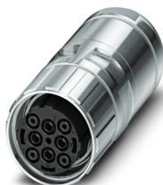
Connettore per cavi, diritto, lungo, Bloccaggio a vite, M40, numero poli: 2+3+PE, tipo di connessione del contatto: Femmina, schermata: sì, grado di protezione: IP67, diametro cavi: 9 mm ... 14 mm, numero poli: 6, tipo di connessione: Connessione a crimpare, serie: SM, Questo articolo è in continuo adattamento. Alternativa senza piombo secondo RoHS II senza eccezione 6c (Pb < 0,1%) possibile in anticipo su richiesta.
