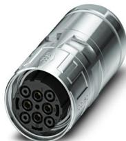
Connettore per cavi, diritto, SPEEDCON, M40, numero poli: 2+3+PE, tipo di connessione del contatto: Femmina, schermata: sì, grado di protezione: IP67, diametro cavi: 20,5 mm ... 26,5 mm, numero poli: 6, tipo di connessione: Connessione a crimpare, serie: SM, Questo articolo è in continuo adattamento. Alternativa senza piombo secondo RoHS II senza eccezione 6c (Pb < 0,1%) possibile in anticipo su richiesta.
