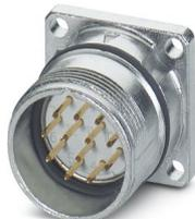
M23, Connettore per apparecchi anteriore, serie: RC, diritto, schermati: sì, Bloccaggio a vite, Numero di poli: 17, Senso di rotazione: standard, tipo di connessione del contatto: Spina, A saldare a mano, O-ring assiale, 4x Ø 2,7 mm, codifica: N, Questo articolo è in continuo adattamento. Alternativa senza piombo secondo RoHS II senza eccezione 6c (Pb < 0,1%) possibile in anticipo su richiesta.
