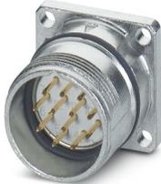
M23, Connettore per apparecchi anteriore, serie: RC, diritto, schermati: sì, Bloccaggio a vite, Numero di poli: 12, Senso di rotazione: standard, tipo di connessione del contatto: Spina, Connessione a crimpare, O-ring radiale, 4x Ø 2,7 mm, Spessore della parete min.: 3 mm, codifica: N, Prodotto alternativo secondo RoHS II senza eccezione 6c (Pb < 0,1 %) cod. art.: 1242519
