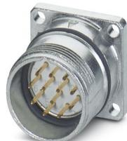
M23, Connettore per apparecchi anteriore, serie: RC, diritto, schermati: sì, Bloccaggio a vite, Numero di poli: 6, Senso di rotazione: standard, tipo di connessione del contatto: Spina, Connessione a crimpare, O-ring assiale, 4x Ø 3,2, codifica: N
