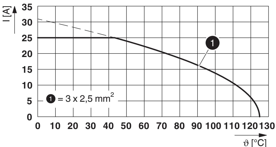
$I$  = intensità di corrente,  $\vartheta$  = temperatura ambiente,  $3 \times 25 \text{ A}$
