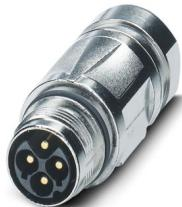
Connettore per giunti, diritto, per bloccaggio standard e SPEEDCON, M17, numero poli: 3+PE, tipo di connessione del contatto: Spina, schermata: sì, grado di protezione: IP67, diametro cavi: 5 mm ... 8 mm, numero poli: 4, tipo di connessione: Connessione a crimpare, serie: ST, Questo articolo è in continuo adattamento. Alternativa senza piombo secondo RoHS II senza eccezione 6c (Pb < 0,1%) possibile in anticipo su richiesta.
