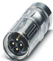
Connettore per cavi, diritto, SPEEDCON, M17, numero poli: 3+PE, tipo di connessione del contatto: Spina, schermata: sì, grado di protezione: IP67, diametro cavi: 8 mm ... 10 mm, numero poli: 4, tipo di connessione: Connessione a crimpare, serie: ST, Prodotto alternativo secondo RoHS II senza eccezione 6c (Pb < 0,1 %) cod. art.: 1242334
