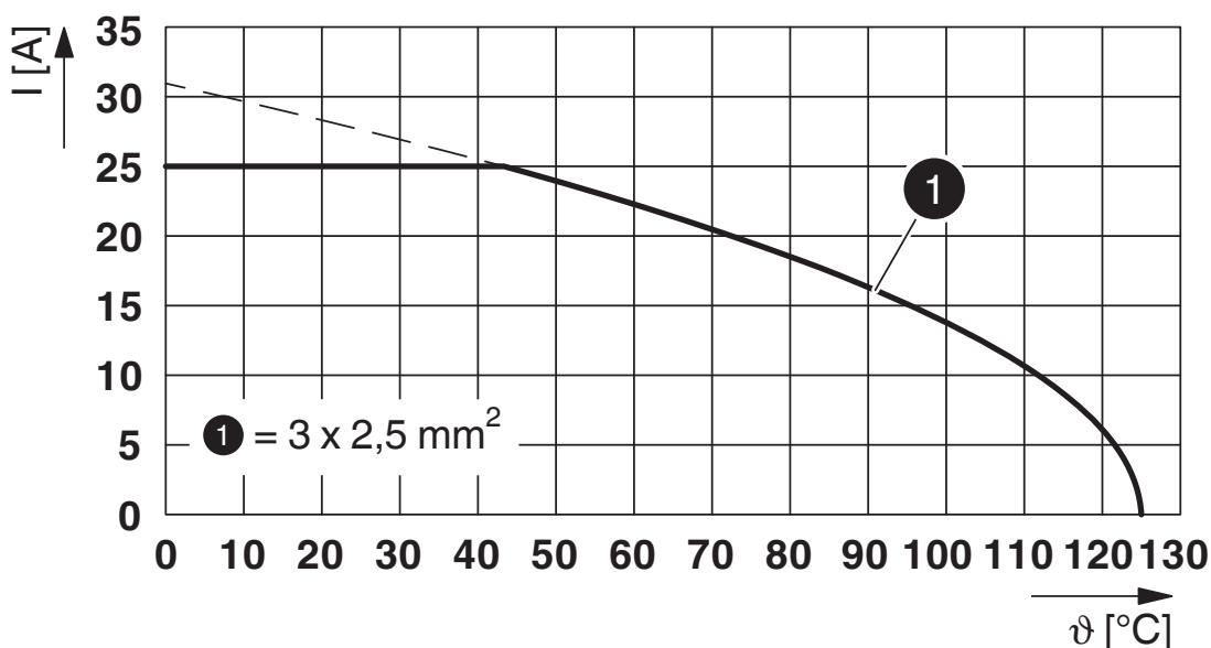
$I$  = intensità di corrente,  $\vartheta$  = temperatura ambiente,  $3 \times 25$  A
