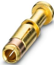
Contatto a crimpare, Femmina, tornito, Contatto singolo, diametro contatti: 2 mm, intervallo di crimpatura: 1 mm<sup>2</sup> ... 2,5 mm<sup>2</sup>, Prodotto alternativo secondo RoHS II senza eccezione 6c (Pb < 0,1 %) cod. art.: 1237423
