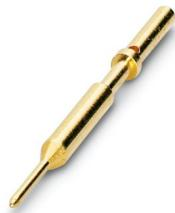
Contatto a crimpare, Spina, tornito, diametro contatti: 0,6 mm, intervallo di crimpatura: 0,14 mm<sup>2</sup> ... 0,34 mm<sup>2</sup>, Prodotto alternativo secondo RoHS II senza eccezione 6c (Pb < 0,1 %) cod. art.: 1242311
