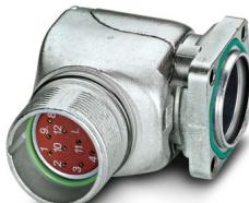
Connettore per apparecchi anteriore, angolato, orientabile, Bloccaggio a vite, M23, numero poli: 17, tipo di connessione del contatto: Spina, O-ring assiale, 4x Ø 3,2, schermata: sì, misura flangia: 26 mm x 26 mm, numero poli: 17, tipo di connessione: Connessione a crimpare, serie: RF
