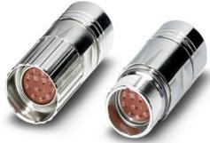
Connettore per giunti, diritto, Bloccaggio a vite, M23, numero poli: 12, tipo di connessione del contatto: Femmina, schermata: sì, grado di protezione: IP67, diametro cavi: 5 mm ... 13,2 mm, numero poli: 12, tipo di connessione: Connessione a crimpare, serie: RF, Prodotto alternativo secondo RoHS II senza eccezione 6c (Pb < 0,1 %) cod. art.: 1242262
