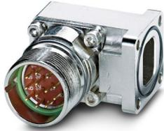
Connettore per apparecchi anteriore, angolato, fisso, Bloccaggio a vite, M23, numero poli: 12, tipo di connessione del contatto: Spina, O-ring assiale, 4x Ø 3,2, schermata: sì, misura flangia: 26 mm x 26 mm, numero poli: 12, tipo di connessione: Connessione a crimpare, serie: RF, Questo articolo è in continuo adattamento. Alternativa senza piombo secondo RoHS II senza eccezione 6c (Pb < 0,1%) possibile in anticipo su richiesta.
