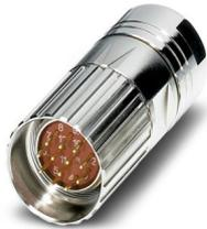
Connettore per cavi, diritto, Bloccaggio a vite, M23, numero poli: 12, tipo di connessione del contatto: Spina, schermata: sì, grado di protezione: IP67, diametro cavi: 6 mm ... 10 mm, numero poli: 12, tipo di connessione: Connessione a crimpare, serie: RF, Prodotto alternativo secondo RoHS II senza eccezione 6c (Pb < 0,1 %) cod. art.: 1242241
