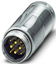
Connettore per giunti, diritto, lungo, per bloccaggio standard e SPEEDCON, M40, numero poli: 4+3+PE, tipo di connessione del contatto: Spina, schermata: sì, grado di protezione: IP67, diametro cavi: 14 mm ... 20,5 mm, numero poli: 8, tipo di connessione: Connessione a crimpare, serie: SM, Questo articolo è in continuo adattamento. Alternativa senza piombo secondo RoHS Il senza eccezione 6c (Pb < 0,1%) possibile in anticipo su richiesta.
