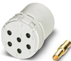
Inserto contatti, M23, numero poli: 6, tipo di connessione del contatto: Femmina, Connessione a crimpare, serie: NC, RC, RM, TU, UC, Questo articolo è in continuo adattamento. Alternativa senza piombo secondo RoHS II senza eccezione 6c ( $Pb < 0,1\%$ ) possibile in anticipo su richiesta.
