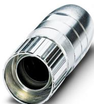
Custodia per connettore circolare, serie: UC, diritto, Bloccaggio a vite, M23, numero poli: 12, schermata: sì, diametro cavi: 2 mm... 14,5 mm, Questo articolo è in continuo adattamento. Alternativa senza piombo secondo RoHS II senza eccezione 6c (Pb < 0,1%) possibile in anticipo su richiesta.
