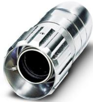
Custodia per connettore circolare, serie: TU, diritto, Bloccaggio a baionetta, M23, numero poli: 12, tipo di connessione del contatto: Femmina, Connessione a crimpare, schermata: sì, diametro cavi: 2 mm... 14,5 mm, Questo articolo è in continuo adattamento. Alternativa senza piombo secondo RoHS II senza eccezione 6c (Pb < 0,1%) possibile in anticipo su richiesta.
